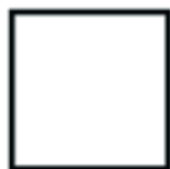
Representación bidimensional de un cubo proyectado perpendicularmente sobre el plano de una de sus caras.
